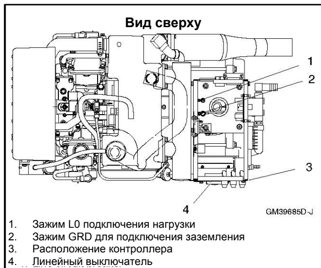
Рисунок 5-9 Расположение выключателя и зажимов L0 и GRD
