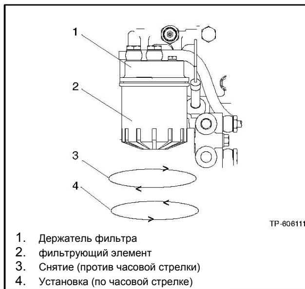
Рисунок 4-3 Центробежный топливный фильтр
