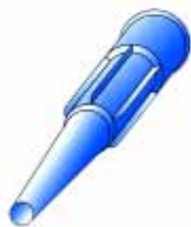
Срез носика для образования круглой капли
