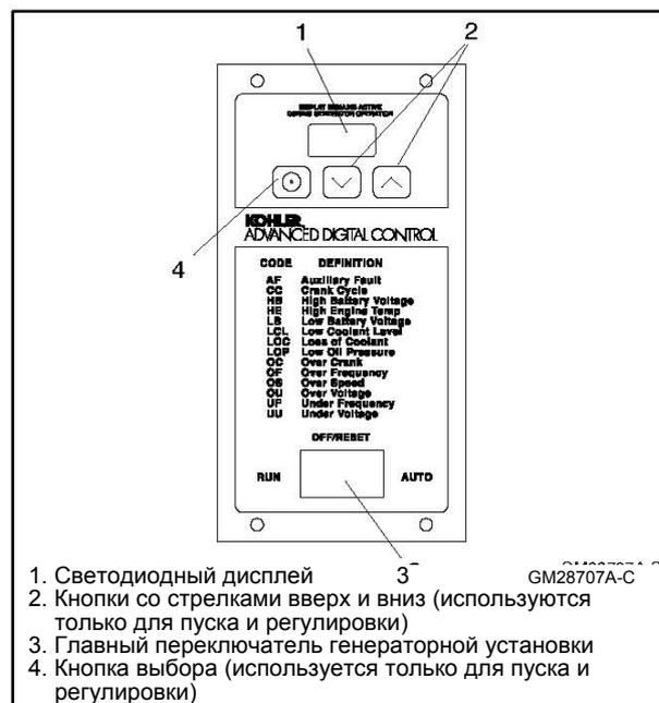
**Рисунок 2-3** Блок управления ADC 2100
